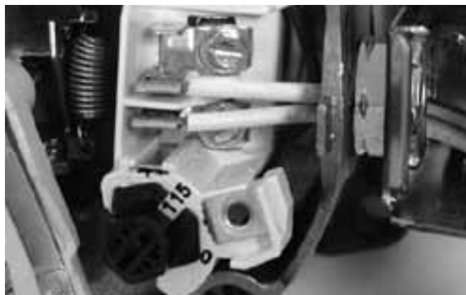
Figura 11: Tensión configurada para 115 voltios, tipo cuadrante.
